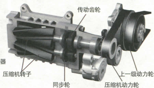
机械增压器构造图
